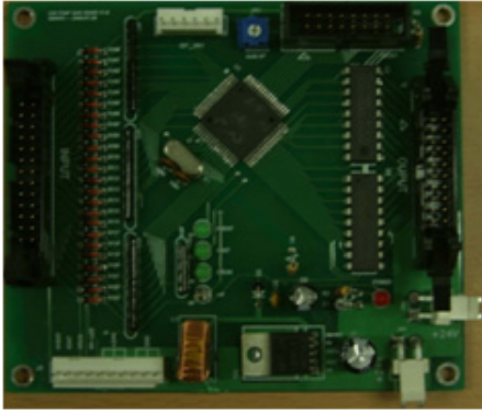
[그림 13] 개발된 밸브 컨트롤 보드 [Fig. 13] Developed valve control board
