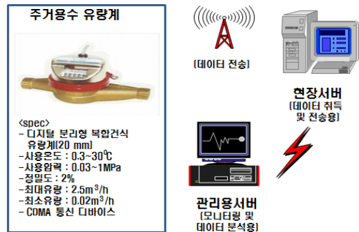
[그림 3] 주거용수사용 실시간 데이터 취득구조 [Fig. 3] The Data Acquisition Structure of the Real Time Residential Water Consumption
