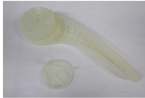
[그림 8] 사상작업 후 광조형 결과물 [Fig. 8] Completion of master model
