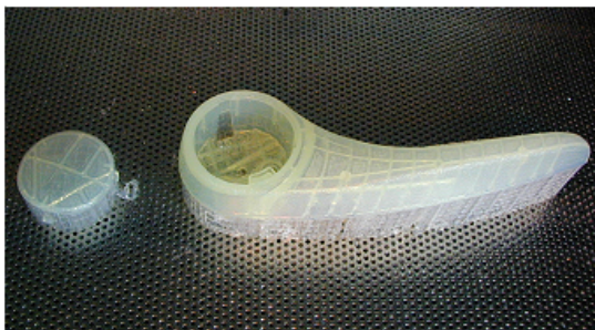
[그림 7] 광조형 완성 [Fig. 7] Finished rapid prototype of grip
