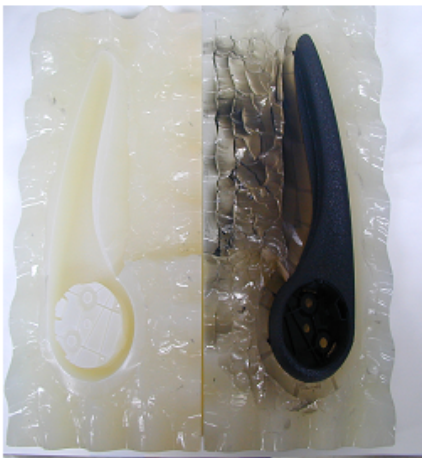
[그림 11] 실리콘 몰드에서 성형된 제품 [Fig. 11] Finished parts from silicon mold
