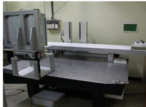
[그림 1] 스테레오 X-선 검색장치 [Fig. 1] The stereo X-ray inspection system
