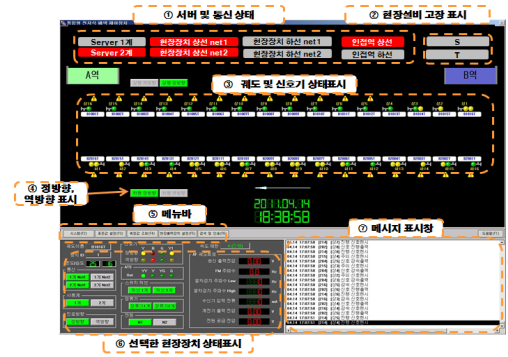
[그림 4] 역제어장치 제어콘솔 화면 [Fig. 4] Control Console Monitor of Station Control Unit
