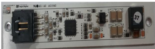
[그림 13] LED 면조명용 AC 직결형 구동기의 PCB 회로 [Fig. 13] PCB of AC driver for LED flat light
