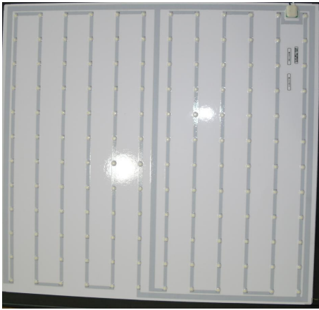
[그림 4] 12x12 FLB의 직렬 회로 구현 [Fig. 4] Implementation of serial FLB circuit
