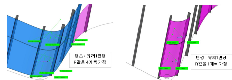
[그림 4] 유리커브패널 보정작업[2] [Fig. 4] Glass curvature modification
