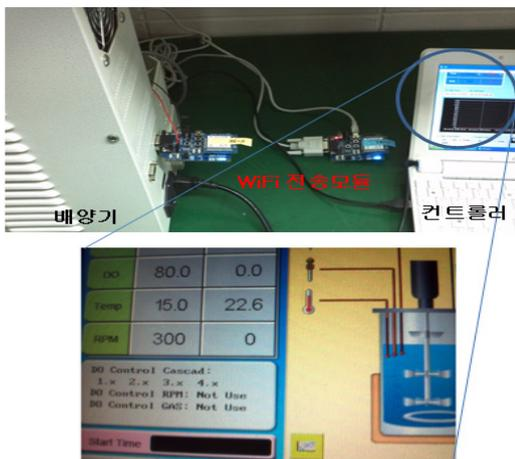
[그림 9] 광생물 반응기 무선 전송 실험 결과
