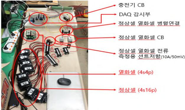
[그림 10] 정상셀 및 열화셀(4:1)간의 셀프에너지 밸런싱 시험
