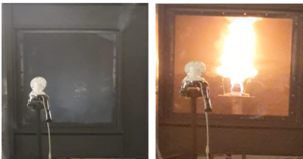
[그림 9] 리튬이온전지 벤트 발생 및 열폭주
