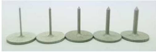
[그림 1] 길이 20mm 스파이크 웨이브가이드( d\varnothing )
