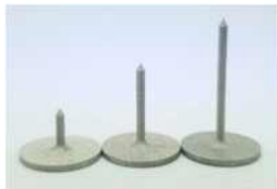
[그림 2] 직경 2mm 스파이크 웨이브가이드(dH)
