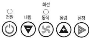
[그림 3] 범용 축사 환풍 제어시스템의 키 버튼
