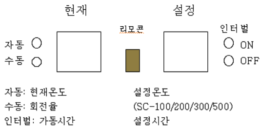
[그림 3] 범용 축사 환풍 제어시스템의 인터페이스
