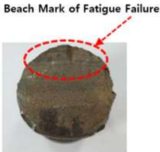
[그림 2] HSU 체결나사 피로 파단면
