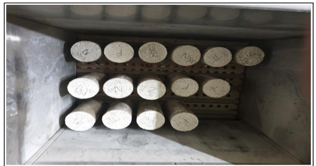
[그림 5] 동결융해 중인 보강 전 콘크리트 시편
