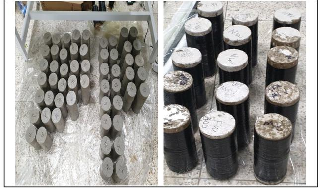
[그림 3] FRP 보강 전후 콘크리트 시편 제작 사진
