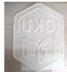
[그림 3] 3D 프린터로 제작한 폼라이너
