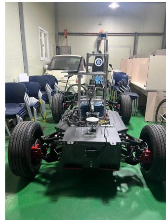
[그림 2] Automated Driving Platform
