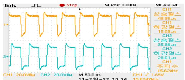
[그림 9] pump mode on후 약 10초 후의 파형
