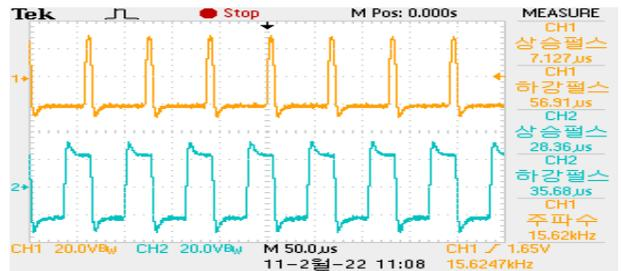
[그림 14] negative direction on 시 PWM 출력파형
