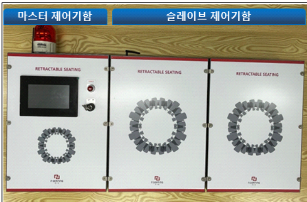
[그림 12] 제어기함 기구 제작 사진
