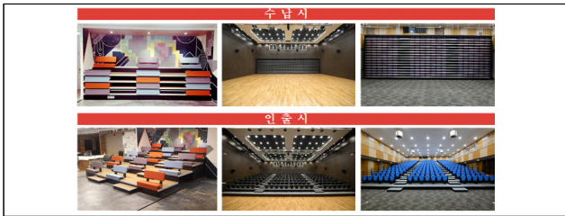
[그림 1] 수납식 관람석의 상태에 따른 비교 사진
