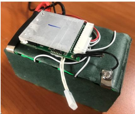
[그림 7] 배변 리프트 리튬이온 배터리와 BMS
