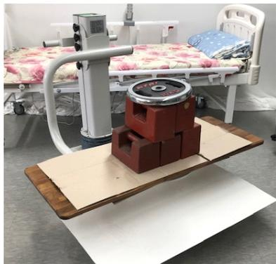
[그림 12] 리프트 상, 하 구동 능력 테스트
