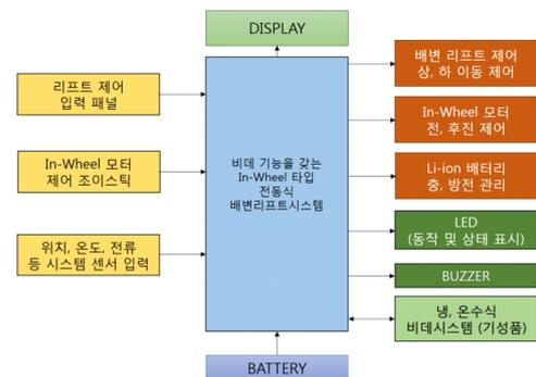
[그림 1] 실용성과 효율성 기반의 배변 리프트 시스템 제어 구성도
