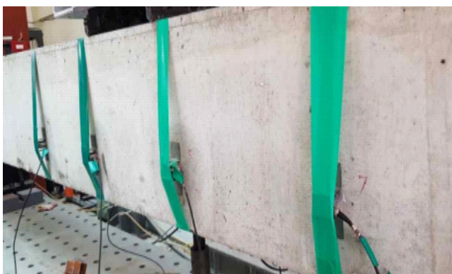
[그림 4] 위험물 저장탱크 기둥의 철근콘크리트 음향방출기술 시험
