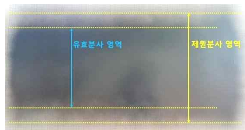
[그림 1] 자동차 보수도장용 스프레이 건의 유효분사 영역
