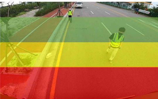
[그림 2] 영상에 위험/경고/정상 영역 설정 예시
