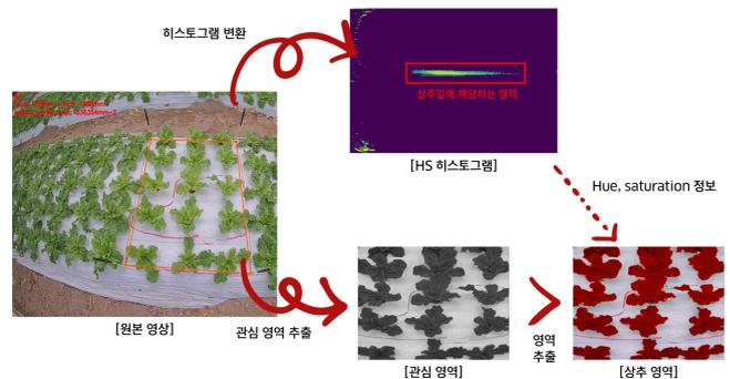
[그림 4] 비전 센서를 이용한 상추 성장 속도 분석 방법
