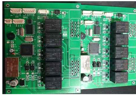
[그림 7] IoT 제어기 PCB 제작
