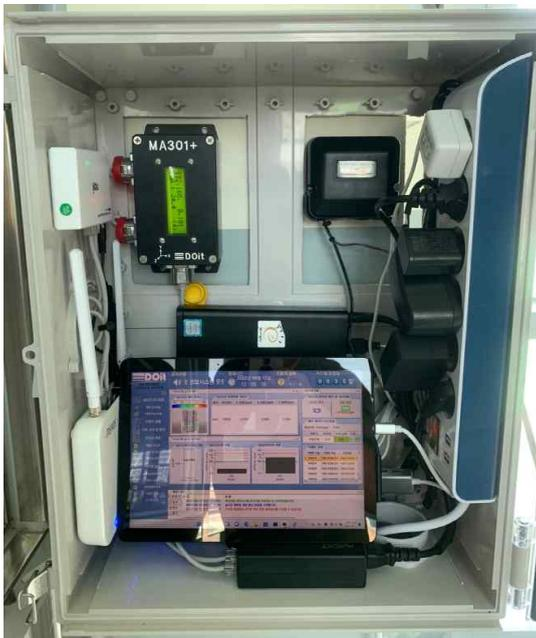
[그림 2] 지진동 및 변위감지 센서
