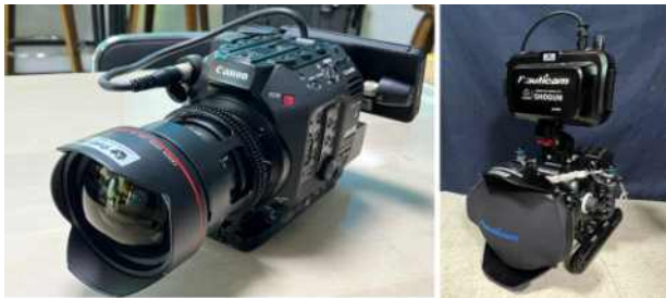
[그림 1] 수중촬영 장비(왼쪽: 카메라 본체, 오른쪽: 방수하우징)
