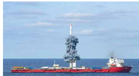
[그림 3] 중국 Floating Barge 해상 발사 장면
