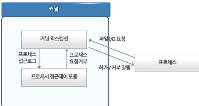
[그림 4] 파일 I/O 모니터링 및 제어 모델
