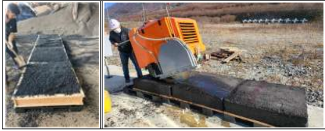
[그림 1] 아스팔트 시편 제작 [그림 2] 아스팔트 시편 절단실험
