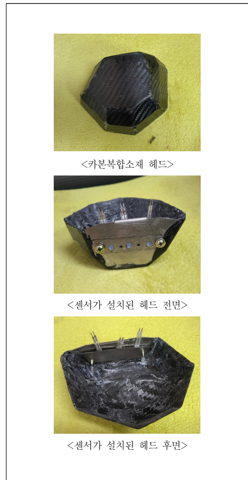
[그림 3] CFRP 헤드 내부 구조
