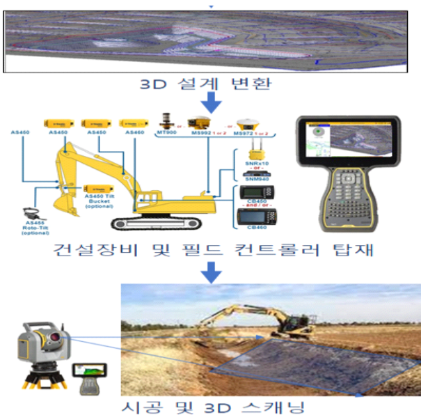
[그림 4] 건설자동화를 위한 3D 설계 및 공간정보 취득 기술 적용 작업공정
