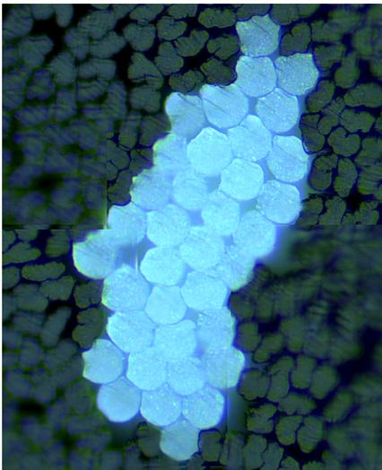
[그림 3] 친환경 및 항균 기능성 Recycle PET FD MOY사 85De 단면분석
