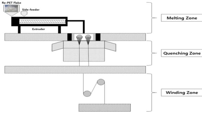
[그림 1] 친환경 및 항균 기능성 Recycle PET FD MOY사 제조 모식도
