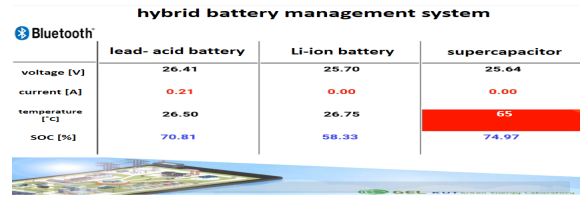
(b) 이상 상황 발생 시 [그림 4] 하이브리드 BMS 모니터링
