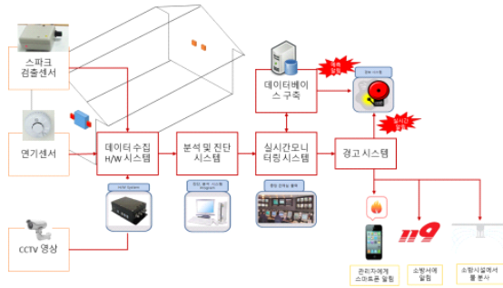
[그림 1] 축사 전기 화재 안전 시스템 구성도
