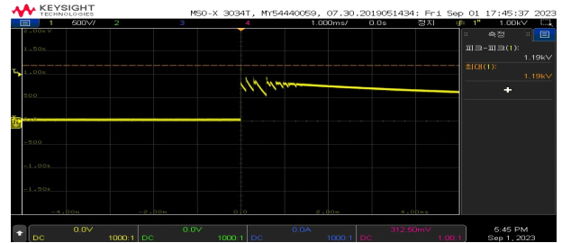
[그림 11] 배터리측 DC 개폐기 동작시 개폐서지 특성
