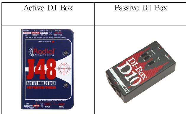
[그림 2] 액티브 DI Box[2] VS 패시브 DI Box[3]
