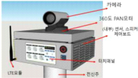
[그림 2] 산악안전시스템 현장 계측기 구성도
