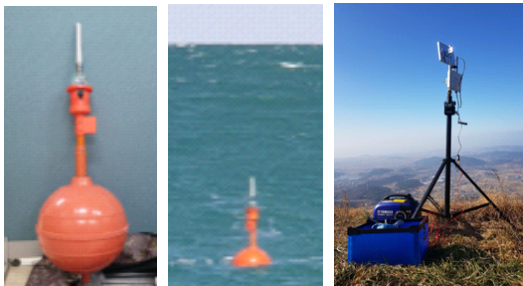
[그림 9] 실험역 검증을 위한 부이 구성 및 소형 육상 기지국
