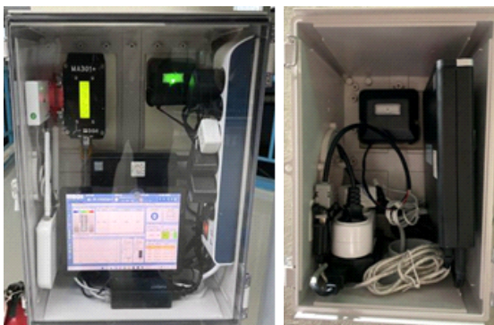
[그림 3] 환경재난 계측 센서 시스템 (좌: 미소지진동 센서, 우: 변이 감지 센서)
