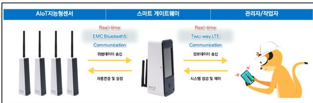
[그림 3] 실시간 위험경보시스템 구성도
