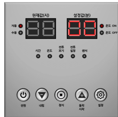
[그림 5] 가축 분뇨 수집 장치용 제어기 인터페이스 패드
