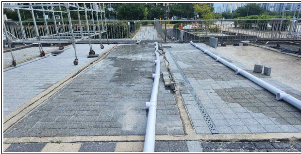
[그림 1] 실규모 인공강우 실험 장치
