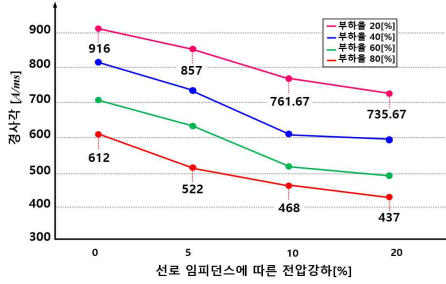
[그림 2] 선로 임피던스에 따른 사고전류의 경사각 특성
