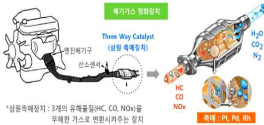
[그림5] 산소센서와 촉매변환기의 위치와 구조
