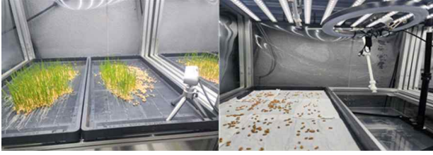
[그림 2] 새싹밀순 데이터 수집 과정(좌: 깊이 센서, 우: RGB 센서)
