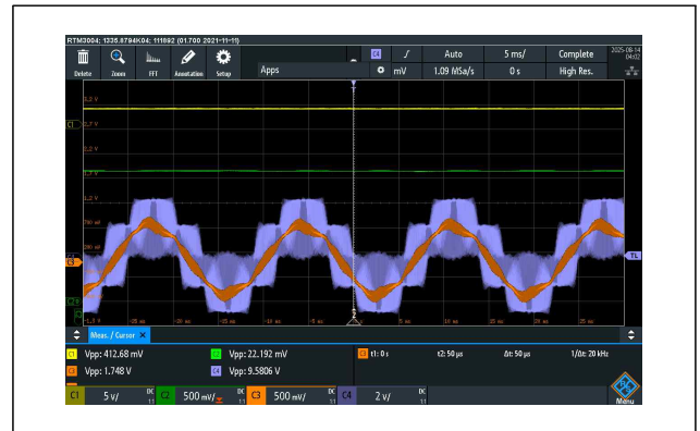
[그림 3] 8kw, 3상 220V 조건에서 SiC-MOSFET PFC(power factor correction) 실험 파형(PWM 상전압 및 전류)
