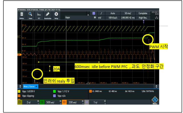
[그림 2] 8kw, 3상 220V 조건에서 전원 투입시 실험 파형
