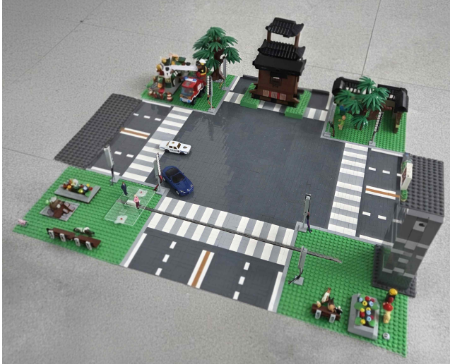
[그림 1] 레고블록을 이용한 우회전 차량 탐지 테스트 베드
