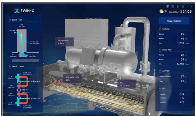
[그림 2] 디지털 트윈 기반 지능형 관제 플랫폼 화면 설계 수집된 데이터는 가상 모델에 반영되어 3D로 시각화되며, 사용자는 이를 통해 설비의 현재 운전 상태를 직관적으로 파악할 수 있다.
