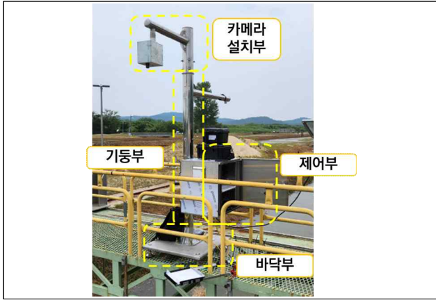
[그림 1] 이동식 초분광 촬영 장치 구성
