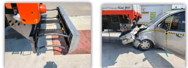
[그림 3] 차량탈부착형 충격흡수시설(TMA1) 충돌시험
