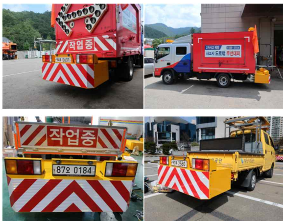
[그림 5] 차량탈부착형 충격흡수시설(TMA) 실용화 사진
